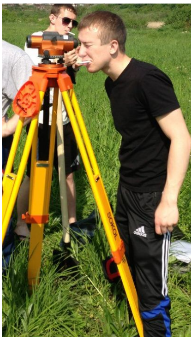
Рис. 1. Работа с оптическим нивелиром (фото авторов)
